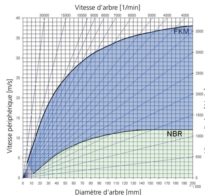
Le diagramme s'applique à un fonctionnement sans pression et à des conditions favorables quant à la lubrification et à la dissipation de chaleur (type OS-F10).
